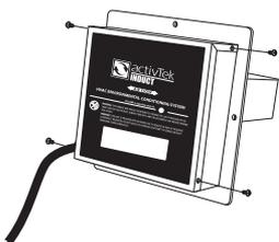
7. Remplacez le couvercle et vissez-le avec les quatre (4) vis originales.
