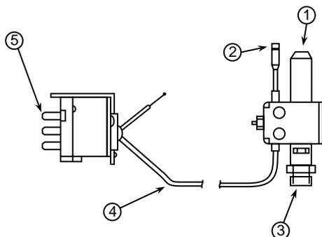
2. La veilleuse automatique doit être installée assez près du brûleur à gaz principal pour assurer que celui-ci soit allumé par la flamme de la veilleuse même lorsque cette flamme a été réduite au point où elle suffit tout juste à maintenir fermés les contacts du commutateur de veilleuse.
