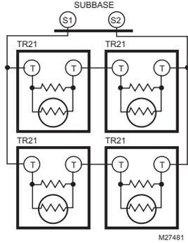
**Fig. 18. Wiring four TR21 (20K ohm) Sensors.**
