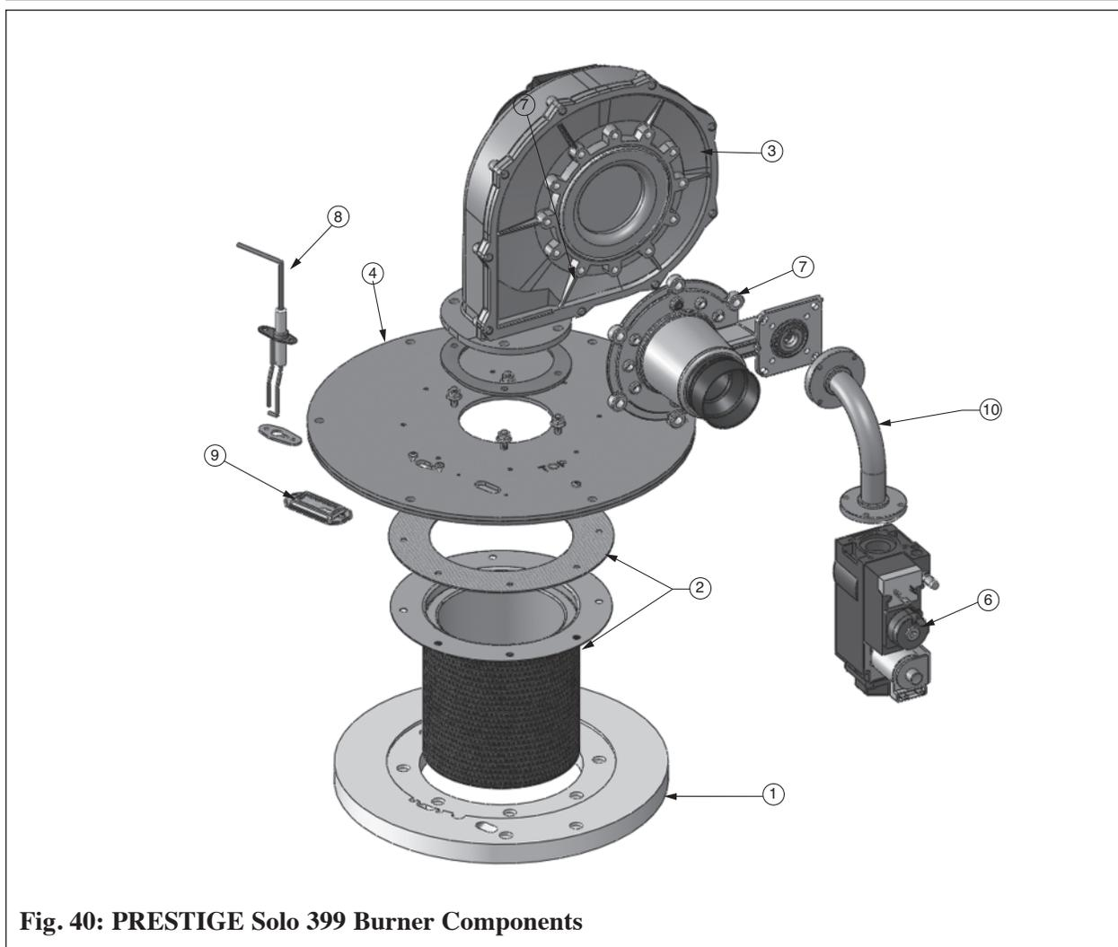
**Fig. 40: PRESTIGE Solo 399 Burner Components**
