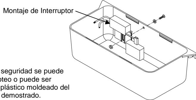
**ADVERTENCIA:** ! Riesgo de choque eléctrico, el interruptor remoto con flotador de seguridad no es sumergible y solamente debe ser conectado a un N.E.C. circuito clase II de no más de 30 voltios.
