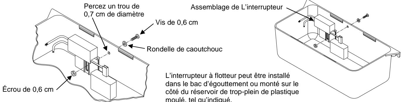
**AVERTISSEMENT :** Risque de choc électrique, l'interrupteur à flotteur n'est pas submersible et devrait être connecté à un circuit N.E.C. de classe II d'eau plus 30 volts.
