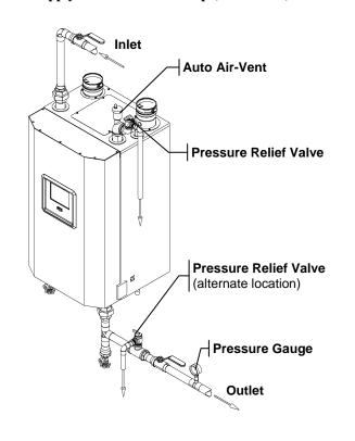
Near Boiler Piping (Tft300-399)
