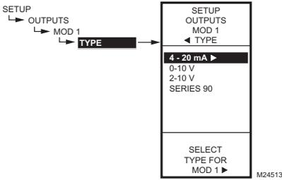
Fig. 47. Setup - Outputs - Mod Out - Type.
