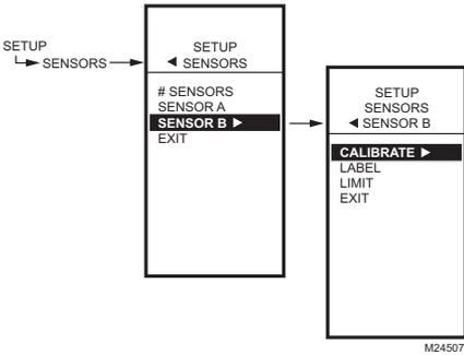
Fig. 41. Setup - Sensors - Sensor B Menu.
